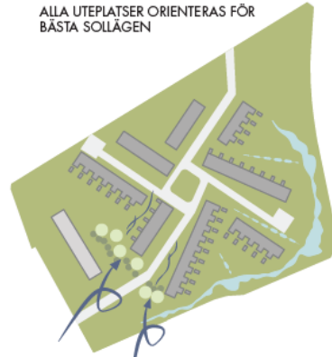
STORA TRÄD PLACERAS MOT SYD-VÄSTVINDAR FÖR ETT BRA MIKROKLIMAT; ÖPPEN DAGVATTENHANTERING I LÅGDELAR
