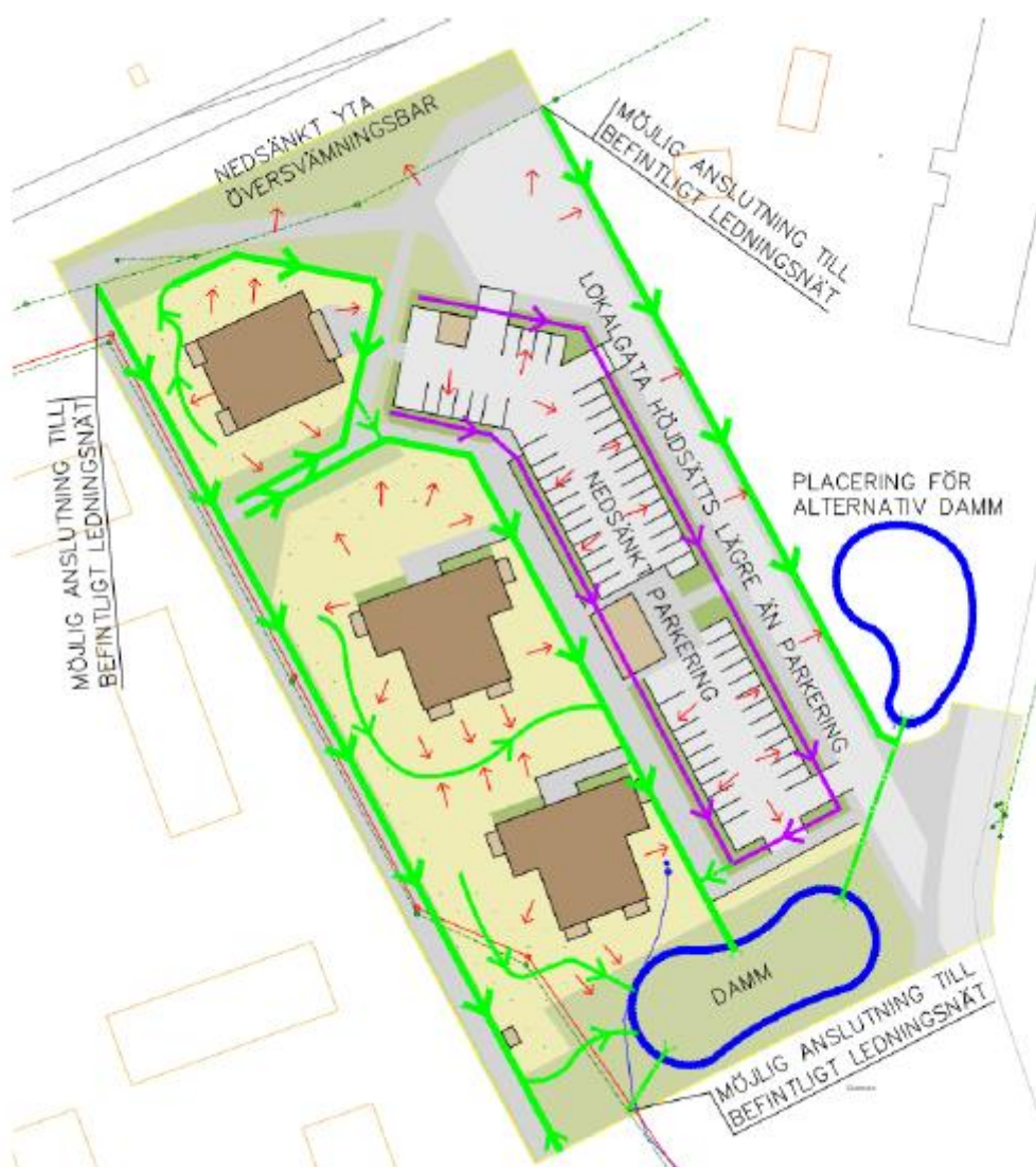
Figur 4. (från Dagvattenutredning av Sweco, 2016-11-28) Utformningsförslag. Tjocka och smala gröna linjer visar svackdiken respektive infiltrationsstråk, där grön pil indikerar flödesriktning. Grön streckprickad linje visar dagvattenledningar. Lila linjer visar regnbäddar. Röda pilar visar avrinningsvägar efter höjdsättning.
