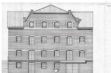
Fasad mot nordväst. Ritning uppritad 1949, byggnaden ändrades genom att två frontespis mot nordväst byggdes samman till en
