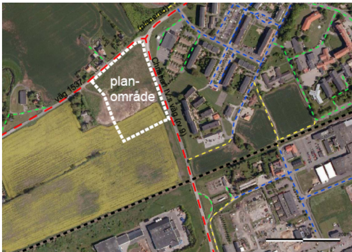
Flygfoto 2010 över gator och kopplingar omkring planområdet. Röda linjer = statliga vägar, blå linjer = kommunala vägar, gröna linjer = enskilda vägar, gula linjer = kommunala gång- och cykelvägar samt svart linje = järnvägen.
